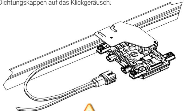
**WARNUNG:** Bringen Sie auf alle nicht verwendeten AC-Steckverbindern Dichtungskappen an, da an diesen Verbindern sonst Strom anliegt, sobald das System mit Strom versorgt wird. Dichtungskappen sind zum Schutz vor eindringender Feuchtigkeit erforderlich.
