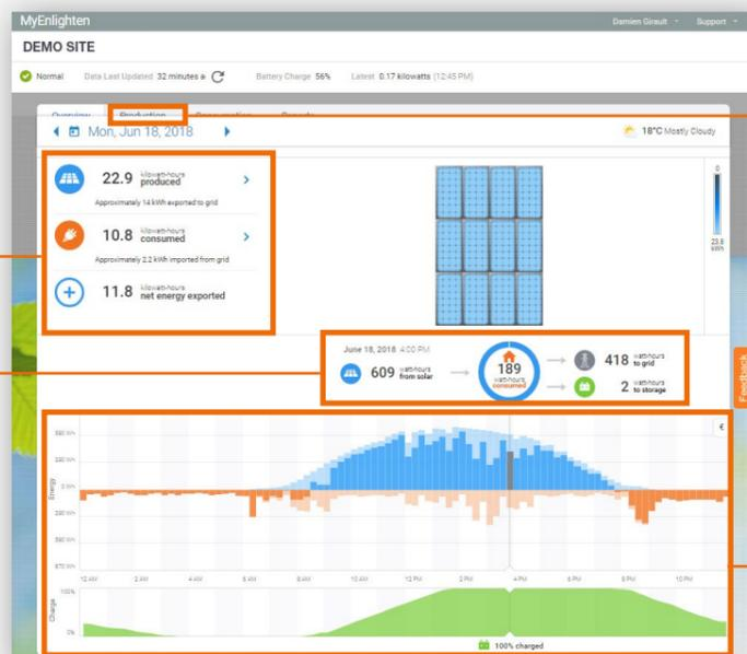
Überwachen Sie aus nächster Nähe die Energieproduktion des Enphase-Systems. Dank dem Wetterdatenverlauf lassen sich Leistungsunterschiede problemlos verstehen.
