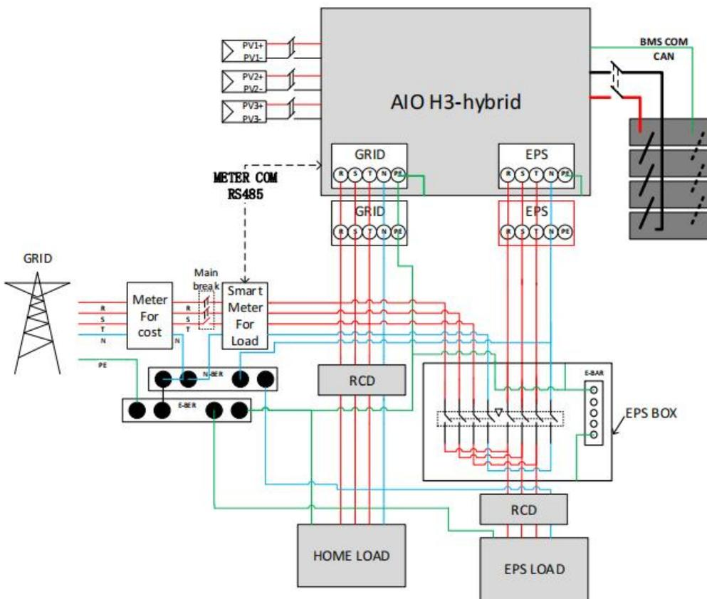
Dieses Diagramm ist ein Beispiel für eine Anwendung, bei der der Neutraleiter im Verteilerkasten vom PE getrennt ist.
